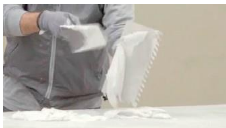
Hladítko s šikmými 10mm zuby / 10mm V-notch trowel
