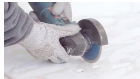
Úhlová bruska s diamantovým kotoučem / Diamond-blade angle grinde
